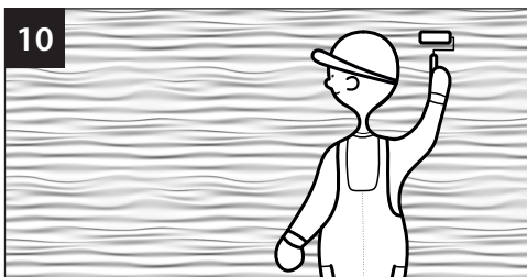
10 Przed przystąpieniem do malowania, powierzchnię paneli należy zagruntować środkiem Weldprimer przy użyciu wałka welurowego.
